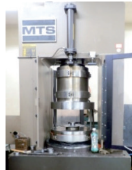
图2 岩石三轴试验仪
